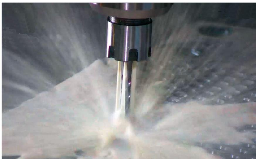
Viele der Futter-Ausführungen von Kato sind mit einer inneren Kühlmittelzufuhr ausgestattet, um den Fluidstrahl gezielt an die Schneiden des Werkzeugs zu leiten (© Kato)
